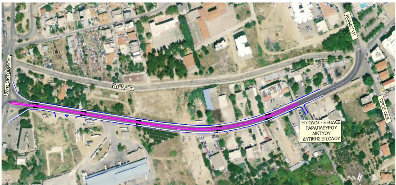
Εικόνα 5.112: Προτεινόμενη διαμόρφωση οδού Τρ. Μιχαλίδη με κατασκευή διαχωριστικής νησίδας
