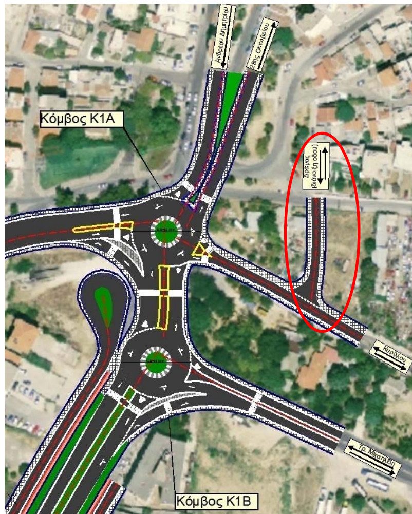
Εικόνα 8.6:Περιοχή κόμβου Κ1 - Διάνοιξη /επέκταση οδού Δράμας
