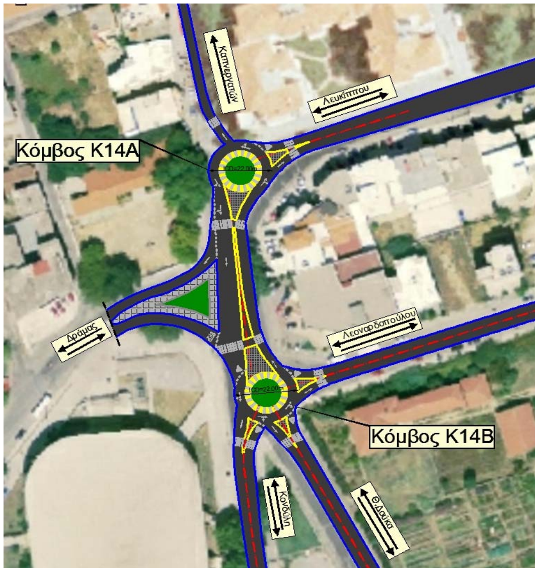
Εικόνα 7.16: Εναλλακτικός σχεδιασμός κόμβου Κ14 με διακοπή τμήματος των κυκλικών κόμβων
