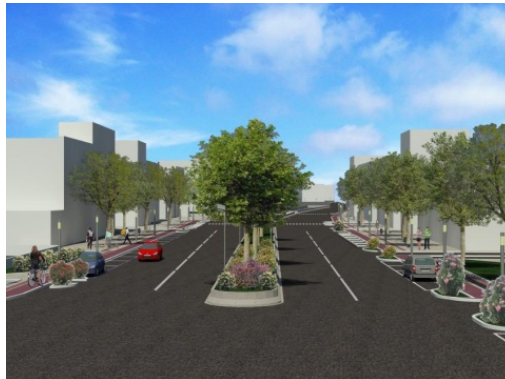
Εικόνα 5.100: Προτεινόμενη διατομή Λεωφόρου Στρατού: Διαχωρισμός κατευθύνσεων κατασκευή κεντρικής νησίδας
