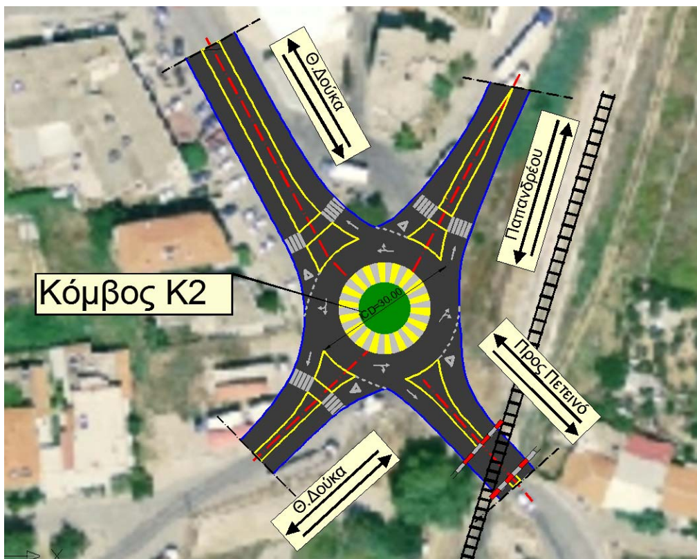
Εικόνα 3.4: Προτεινόμενη σχεδίαση κυκλικού κόμβου με ισόπεδη διέλευση της Σ.Γρ.στη θέση Θ1
