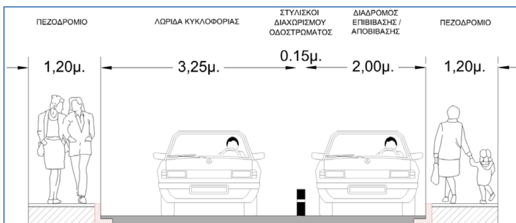
Εικόνα 5.9: Διαμόρφωση Οδού Ανθ. Μιλτιάδη Γεωργίου ως ήπιας κυκλοφορίας με διαχωρισμό του οδοστρώματος για τη δημιουργία διαδρόμου επιβίβασης / αποβίβασης
